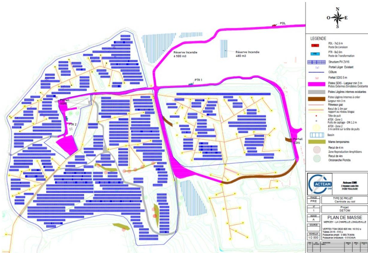
L'implantation des tables tient compte de la présence des équipements nécessaires au bon fonctionnement de l'installation existante et particulièrement des réseaux de captage des biogaz et des lixiviats.
